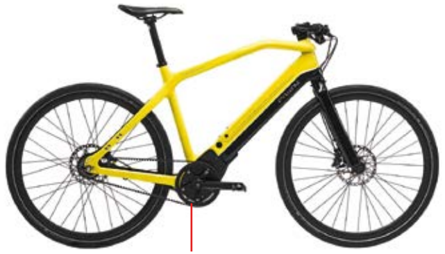
Version Riemenantrieb mit Nuvinci Nabenschaltung
